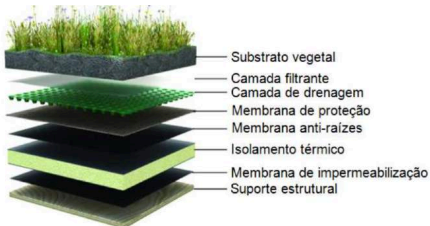
Figura 2.16-Cobertura invertida, (Silva, 2012)
